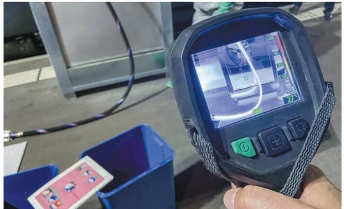
Durch den Temperaturunterschied lässt sich das Niveau des heißen Öls in Reservisten mit der Wärmebildkamera leicht erkennen.
