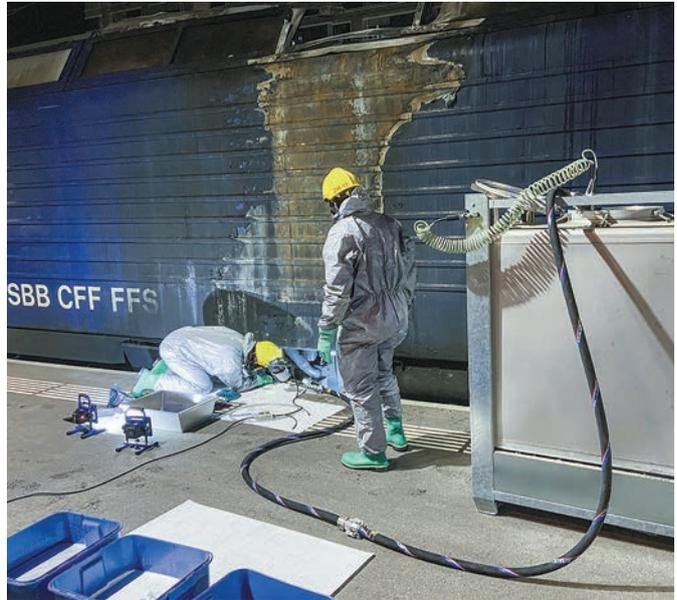
Die Einsatzkräfte lassen das Öl über ein seitliches Ölablassventil in eine Auffangwanne ab, von wo es mit einer Fasspumpe in einen temperaturbeständigen Edelstahlcontainer gepumpt wird.
