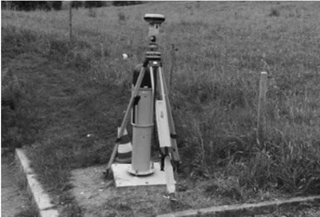
Eingerichtete Permanentstation (während Einmessung mit GPS) am Hangrutschgebiet Mittelteilbach. (Bild: GeoZ)
