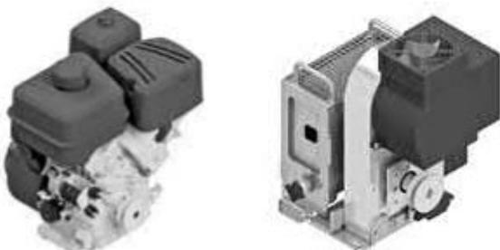
Aus Viertakt (links) wird Gleichstrom (rechts). Prototypen elektrischer Antriebseinheiten sind bei Grün Stadt Zürich im Einsatz. (Bild: Ökozentrum Langenbruck)
