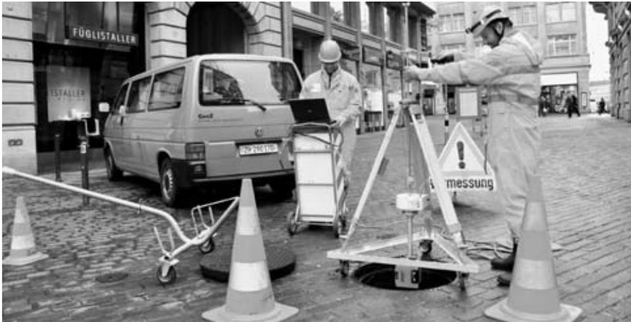
Kanalvermessung mit Laserscanning. (Bild GeoZ)
