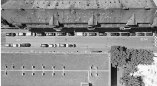
Die Roggenstrasse wurde in drei unterschiedlich gefärbte Flächen unterteilt: In eine Referenzfläche mit herkömmlichem Belag (rechts im Bild) und in zwei Flächen mit einem beigeen und einem hellroten Belag (in der Bildmitte und links). (Bild: TAZ)
